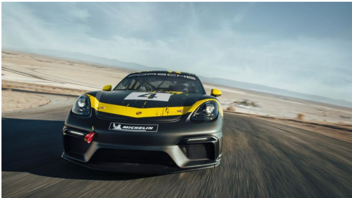
Der Porsche 718 Cayman GT4 Clubsport: Die Fahrer- und Beifahrertüren sowie der Heckspoiler bestehen aus einem Naturfasermix auf Grundlage von Flachs und Hanf.
